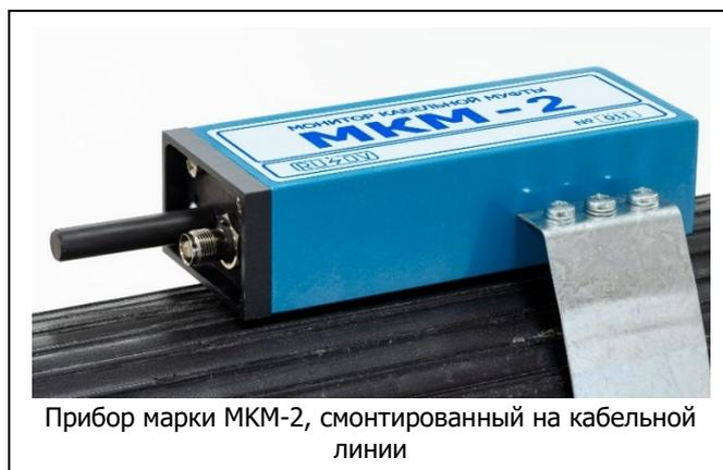
Прибор марки МКМ-2, смонтированный на кабельной линии
